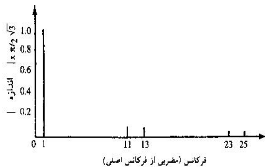
شکل ۱-۱۳ مبدول ۱۲ پالسه الف- شکل موج جریان ب- طیف جریان
